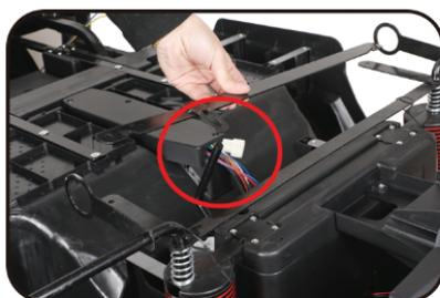
8. Coloque a peça de conexão no quadro frontal
