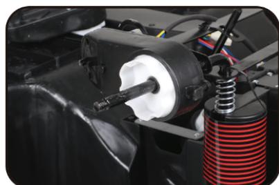
10. Coloque o motor nos eixos
